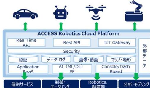
自動制御ロボットをクラウドで管理し、ロボットと人の共働するサービスプラットフォームにより業務革新を実現
