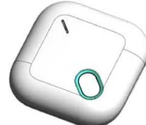
モノや動物の監視を行える。ダウンリンク制御により必要な時だけGPS測位を行い消費電力を抑える設計。
